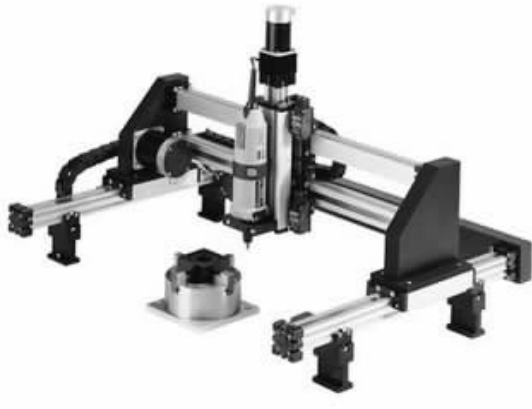
图1-4 直角坐标型工业机器人示意图
