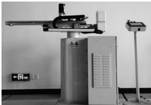
图1-5 圆柱坐标型工业机器人示意图
