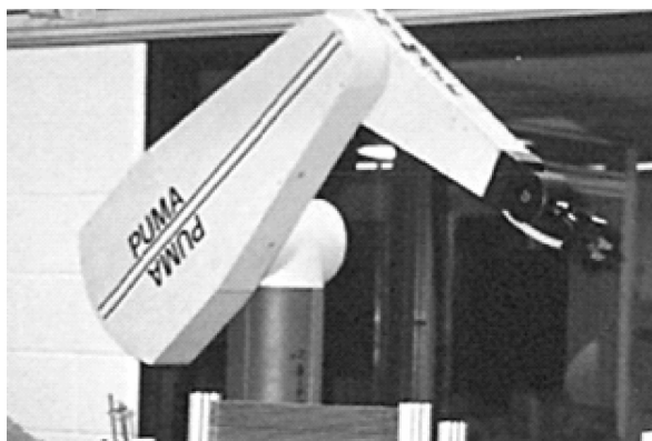
图 1-3 第一台通用型工业机器人 PUMA
