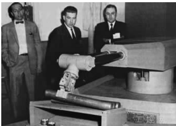
图 1-1 第一台由计算机控制的机器人 Unimate
