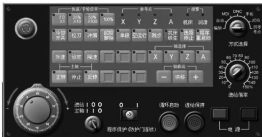
图1-14 J1VMC400B加工中心操作面板
