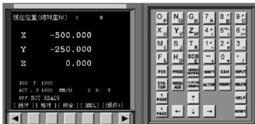
图1-12 FANUC-Oi系统的MDI键盘和CRT界面
