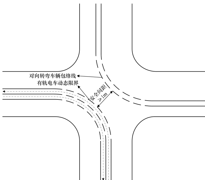
图 4.4.7 有轨电车线路转弯与对向转弯机动车辆最小安全间距示意
