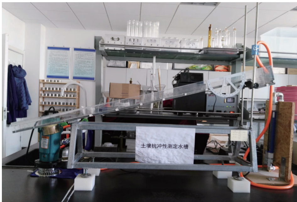
图1 土壤抗冲性测定水槽
