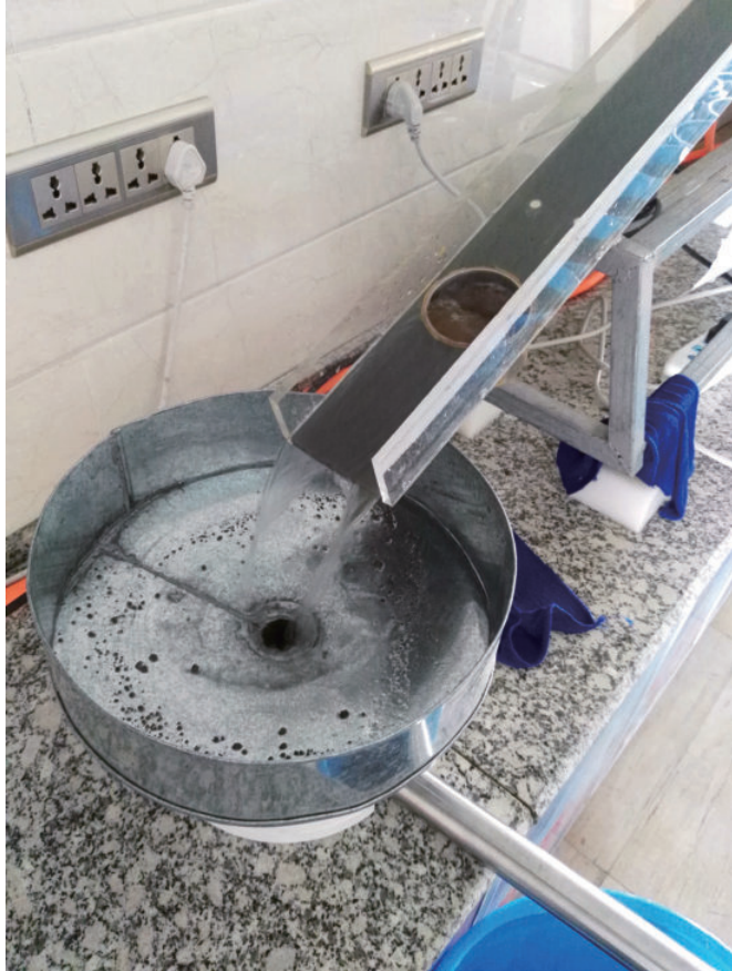
图5 水流转接漏斗工作状
