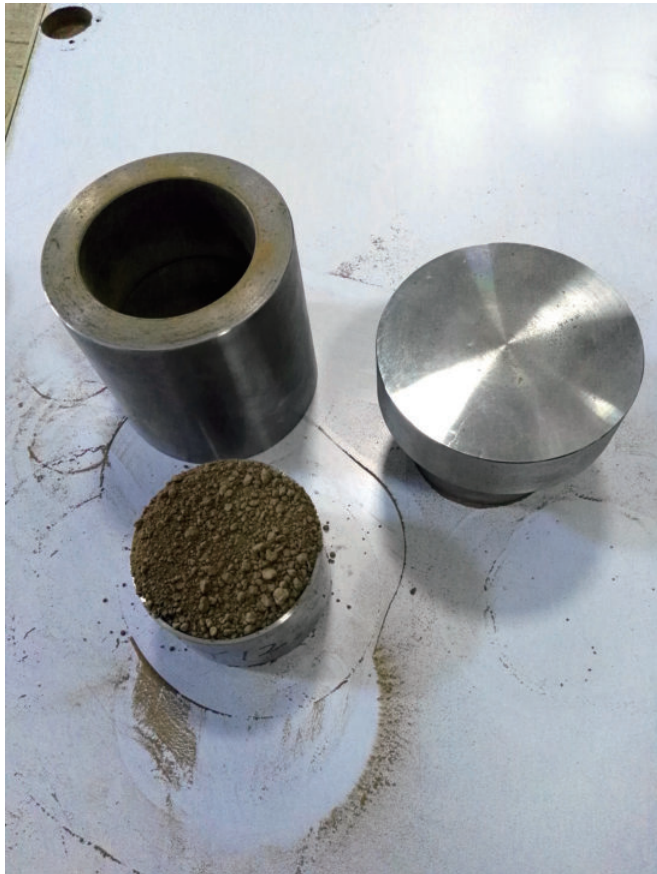
图17 用于扰动土填装的填土器
