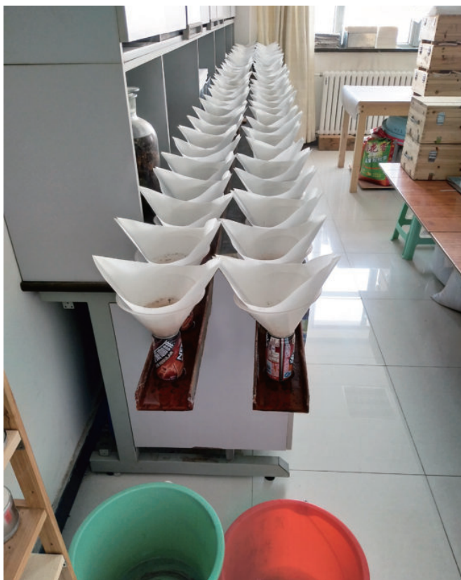
图16 泥沙过滤排水方法之二
