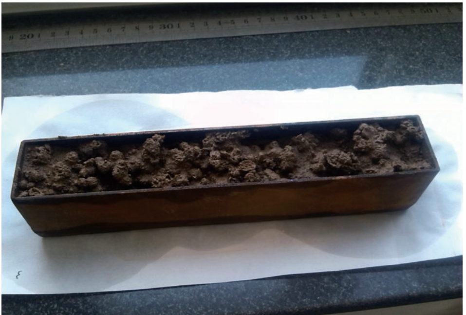
图10 方形取样器冲刷后（填装土）
