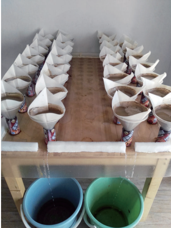
图15 泥沙过滤排水方法之一
