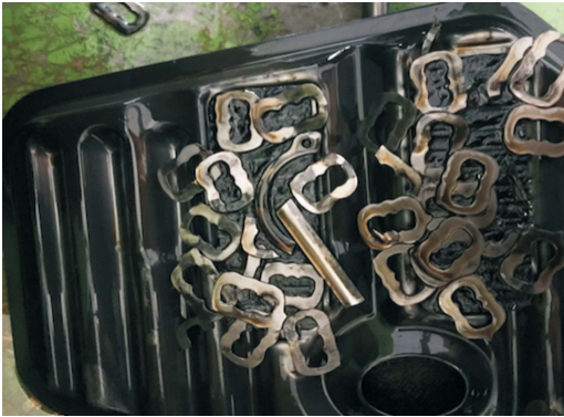
图 1-3 链条上的零散链节和链销
