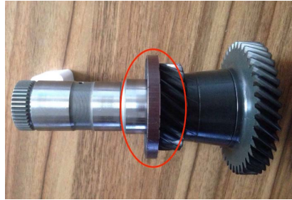
图 1-12 红色圆圈内的信号靶轮已松脱
