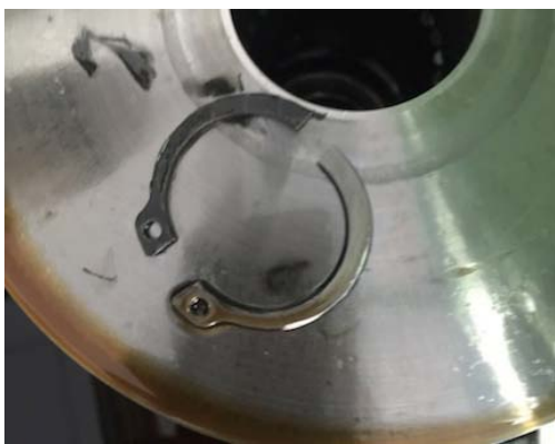
图 1-1 主动链轮轴上已经断掉的卡簧
