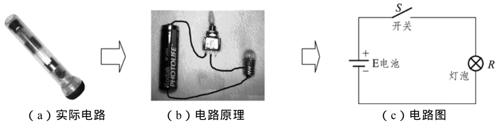
图 1-2 实际电路与电路图的关系
