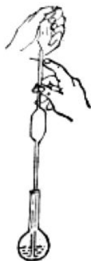
用移液管吸取溶液
