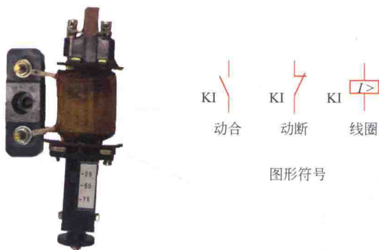
图 1-9 过流继电器的外形及图形符号
