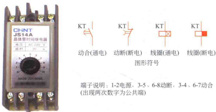
图 1-7 时间继电器的外形及图形符号
