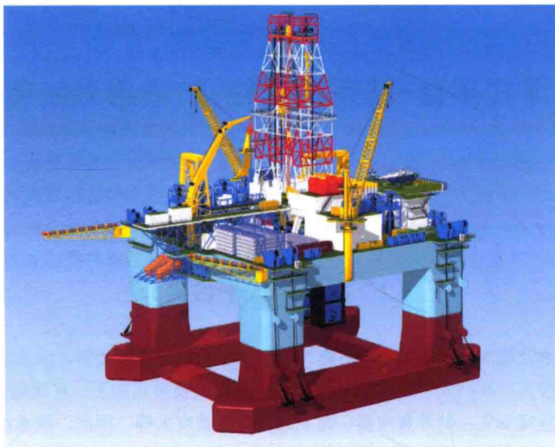
图 1-1 典型深水半潜式钻井平台效果图
