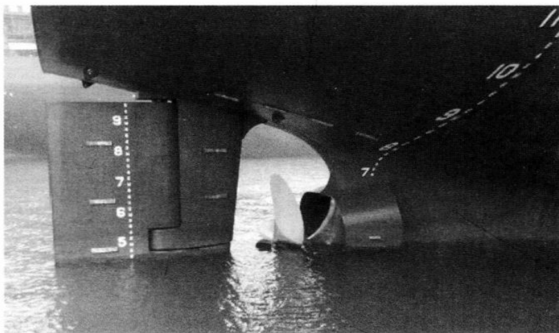
图 1.2 安装于实船上的补偿导管
