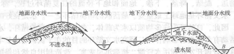
图 1-2 流域地面和地下分水线示意图
