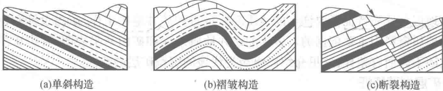
图 1-2 常见的矿层地质构造示意图
