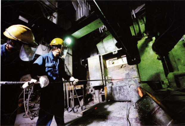
江西铜业铅锌金属有限公司员工正在基夫赛特炉前出铅操作。
