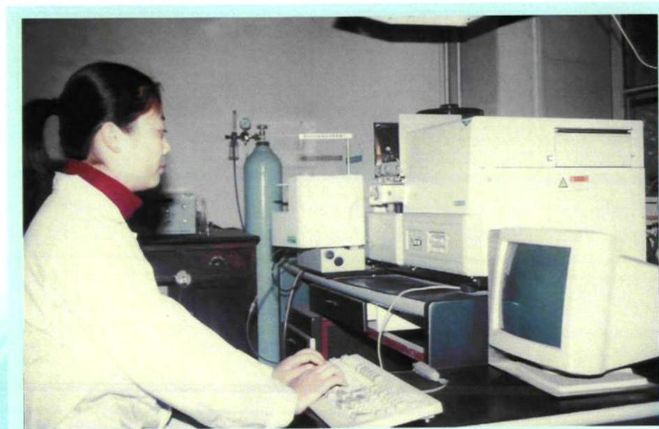
检验人员在使用岛津 AA-6501 型原子吸收仪检测样品中的铝、锌、铜、锰、锶等元素的含量
