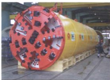
用于城陵矶长江穿越隧道施工的 复合式泥水加压平衡式盾构机
