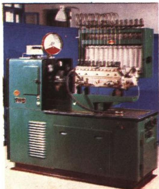
12PSD喷油泵试验台
