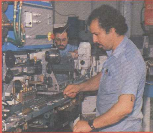
法、瑞專家在重慶罐頭食品廠調試電阻焊制罐生產線
