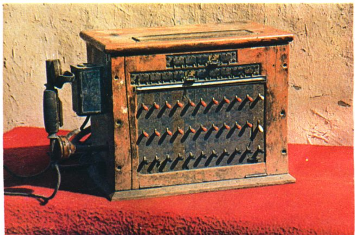
4、1934 年哈密电报局使用的美制(USA)10 门交换机
