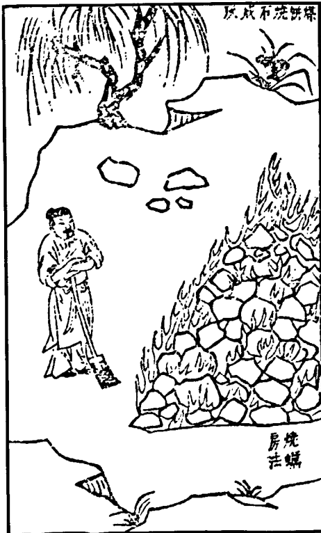
初刻本插图七五：煤饼烧石成灰。
