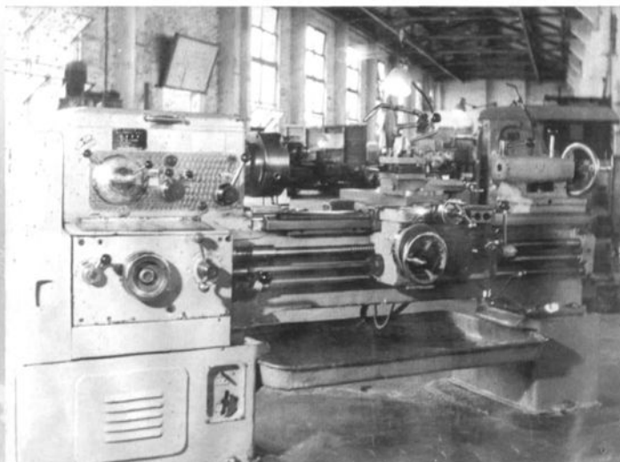
建厂初期发扬自力更生精神， 开发自制CW6140车床设备
