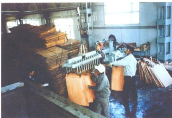
西藏矿业尼木铜矿电解厂生产的铜板
