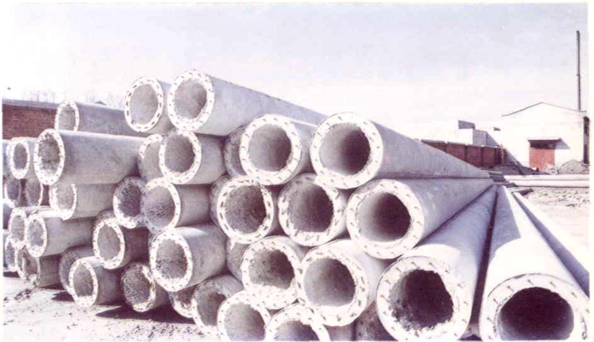
电力预制厂产品——砼杆一角
