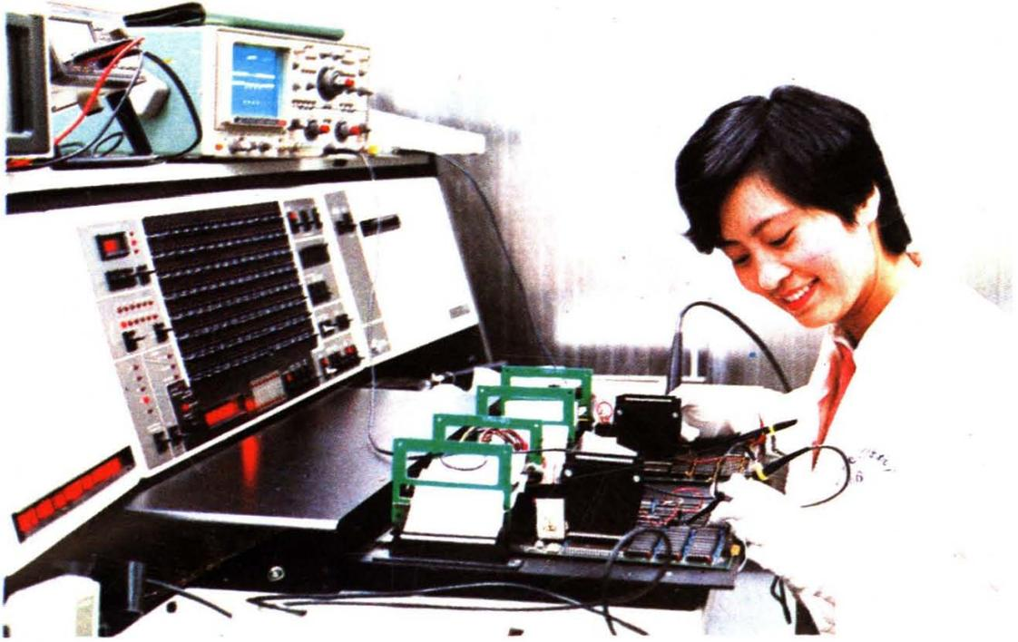
上海电子计算机厂的微型计算机生产调试检修。
