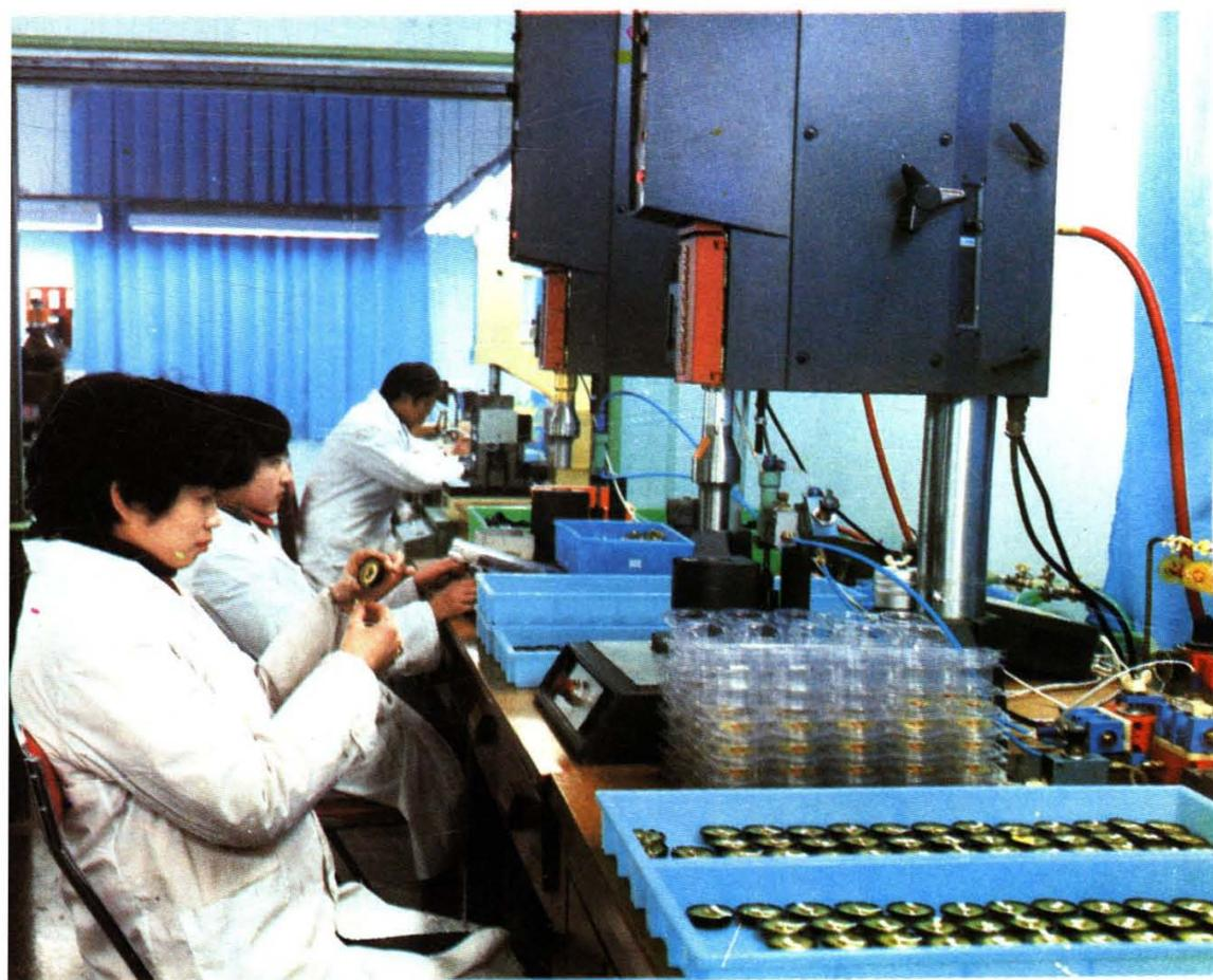
上海电讯器材厂生产的电话机超声波焊接机生产线。
