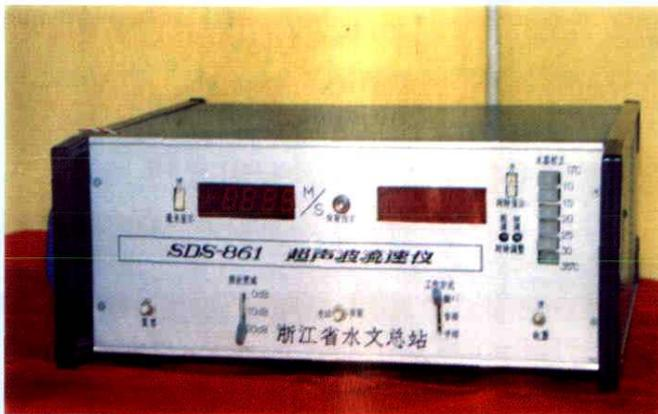
◀ 超声波测流流速仪
