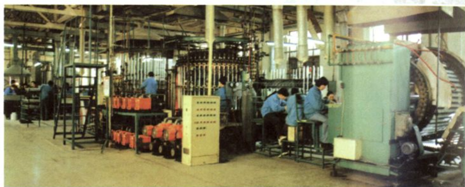
荧光灯自动化生产线
