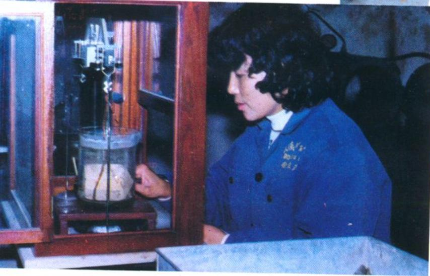
显气孔率测定装置正在称量试样悬水重量
