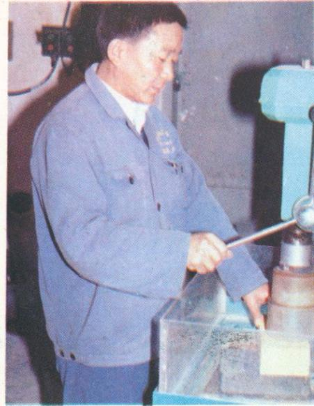
金刚石钻床正在进行荷重软化试样的钻取
