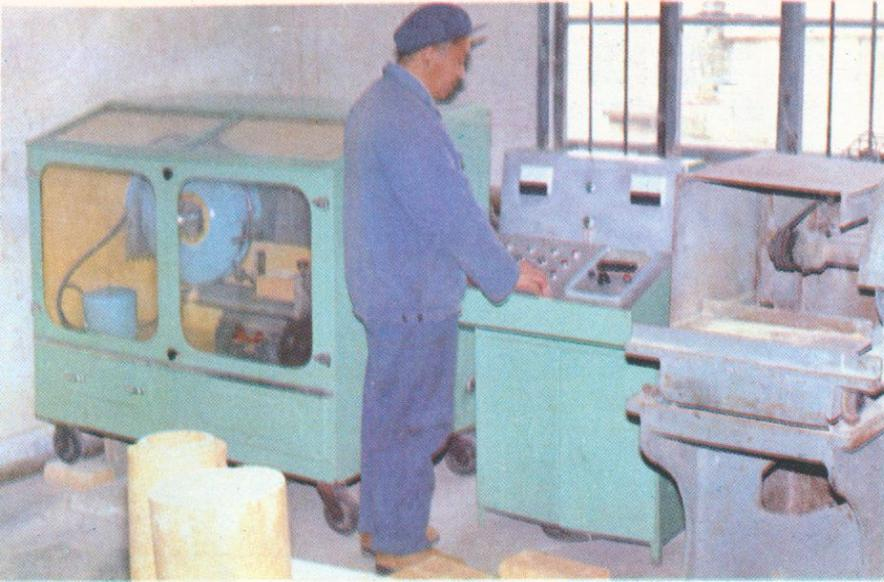
全自动金刚石切割机正在进行试样的切割
