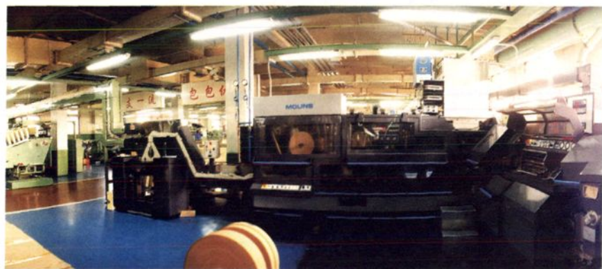
具有世界先进水平的英国帕西姆卷接机组
