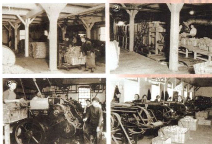
20世纪40年代至60年代使用压梗机①、制盒机②、蒸烟机③、配烟部④
