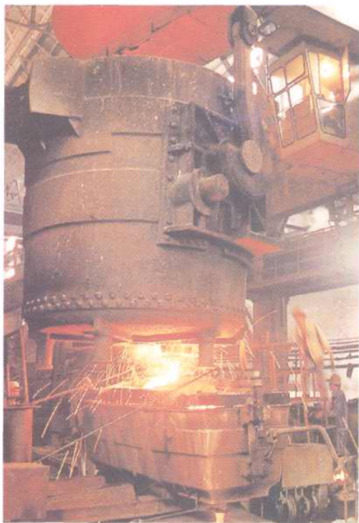
△ 重钢三厂1958年研制成国内第 一台立式连续铸钢机。
