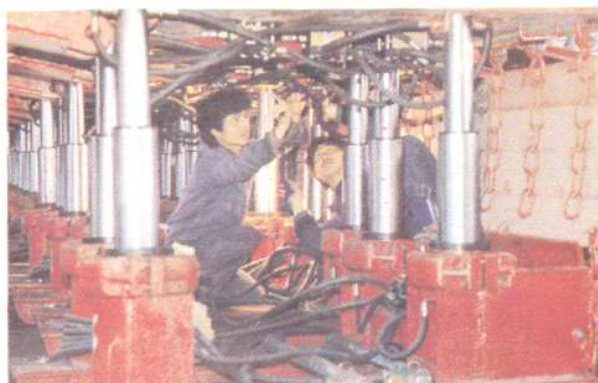
△ 中国煤炭科学院重庆分院与松藻矿务局合作，1976 年研究、设计该局机修总厂制造的 HB 1 -160 型垛式薄煤层液压支架。
