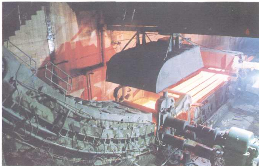
◁ 重庆钢铁公司 1967年研制成功R 10 - 2300毫米弧型连续铸 钢机。
