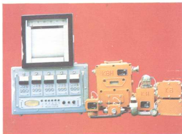
△ 重庆煤矿安全仪器厂 1982 年研制的 AYJ-2 型瓦斯遥测警报断电仪。
