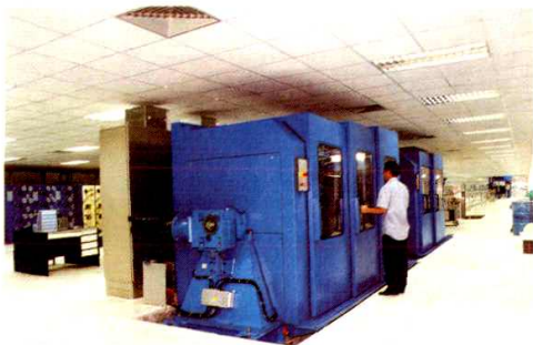
奥星公司带状光缆生产线
