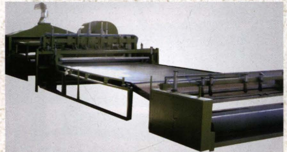
硬质棉、无胶棉生产线
