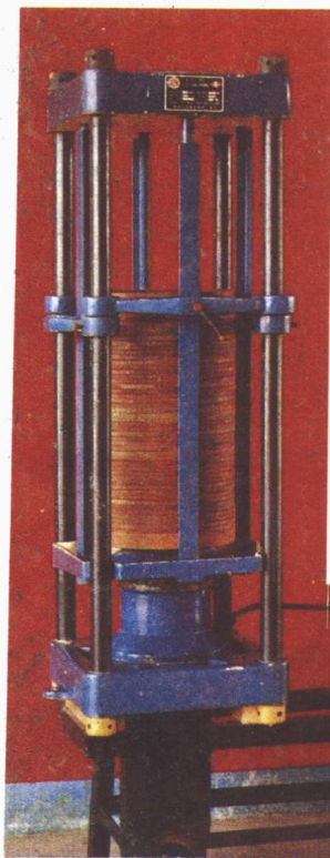
海阳县机械厂大力牌6YS —90立式手动液压榨油机
