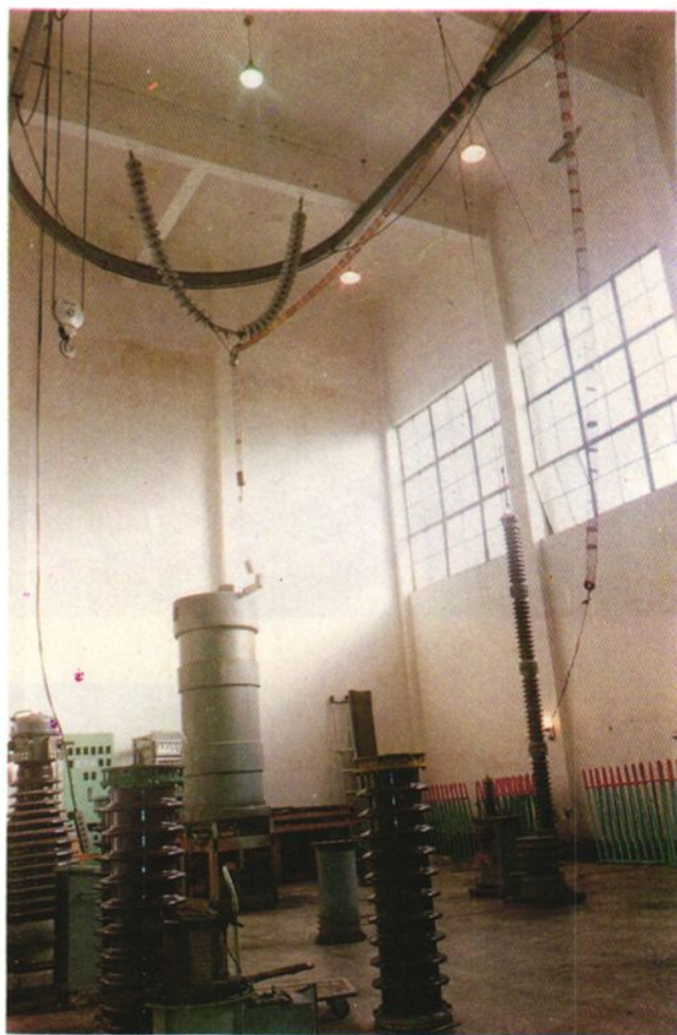
500k v 直流高压试验
