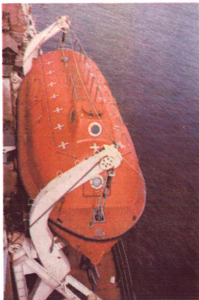
营口玻璃钢造船厂生产的玻璃钢救生艇
