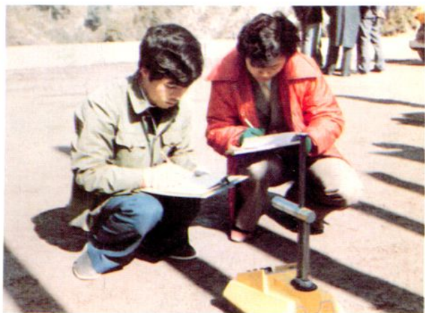
碾压砼容重采用核子密度仪检测
