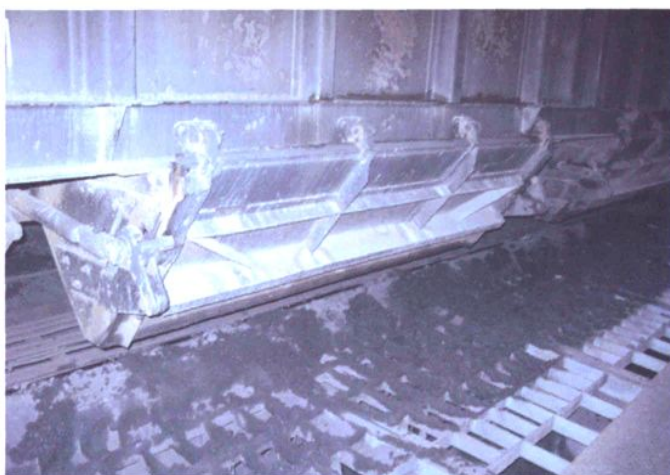
邹县电厂 特有的底开门 运煤火车及卸 煤沟。
