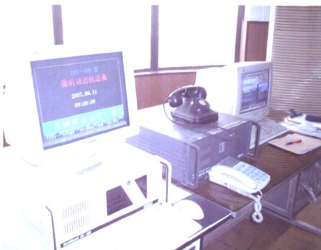
黄台电厂 火车动态轨道 衡实施微机联 网计量。
