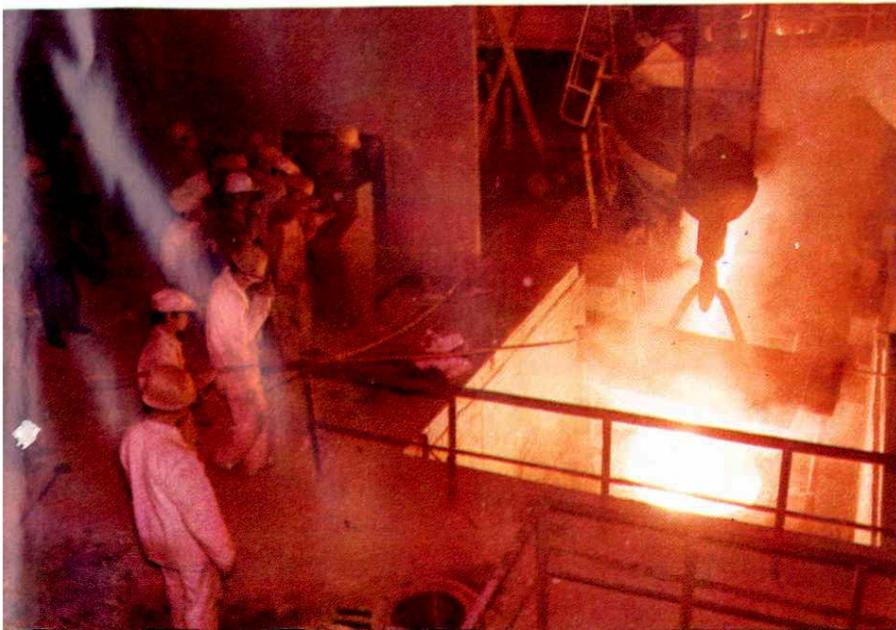
机修厂 5 吨电炉正在出钢
