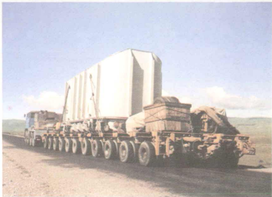
图2-3-3 200吨变压器运输
