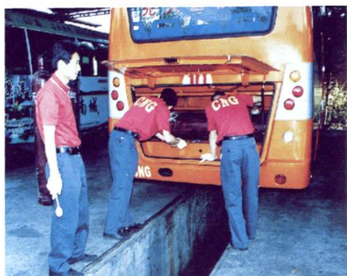
修理工进行“CNG”天然气车辆改装（2006年）
