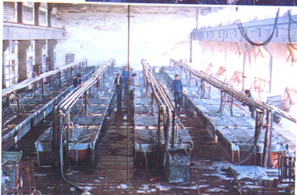
湘潭锰矿电解 锰车间 电解槽
