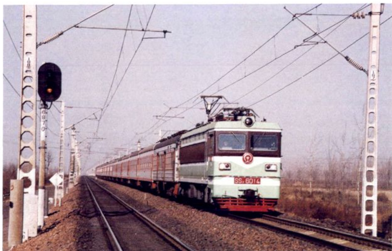
中国第一条采用UM71无绝缘轨道电路四显示自动闭塞的双线电气化铁路京广线郑武段
