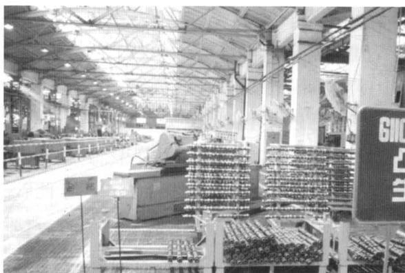
图 2-5 6110 凸轮轴生产线
