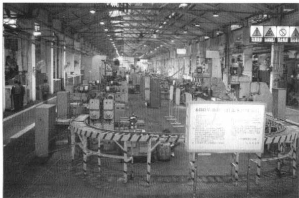
图 2-3 6110 气缸盖生产线
