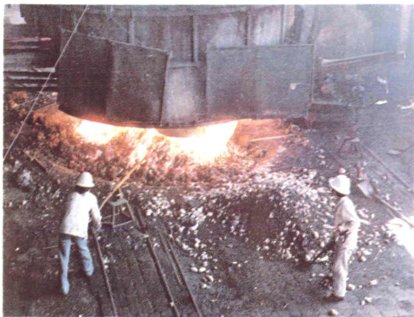
全省现有 3200 千伏安硅铁电炉 2 座，2700 千伏安硅锰电炉 1 座。1983 年，新余钢铁厂在电炉上进行了上部炉体旋转工艺 试验，获 1984 年冶金工业部 科技成果四等奖和江西省优秀科技成果二等奖。图为硅铁电炉正在生产。
