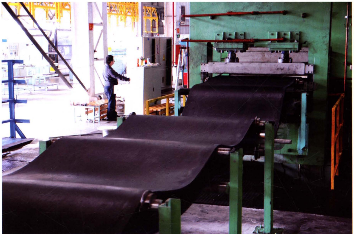
煤炭输送皮带生产线
