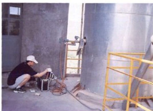
工业锅炉烟尘排放状况监测。
