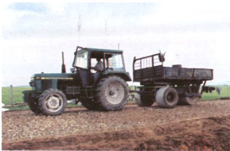
「因陋就简」搞革新自制牵引压路机 西乌旗交通局在机械不全的情况下，
