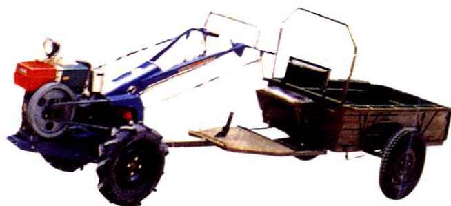
“国光”TY-81 型手扶拖拉机及 0.4 吨拖车
