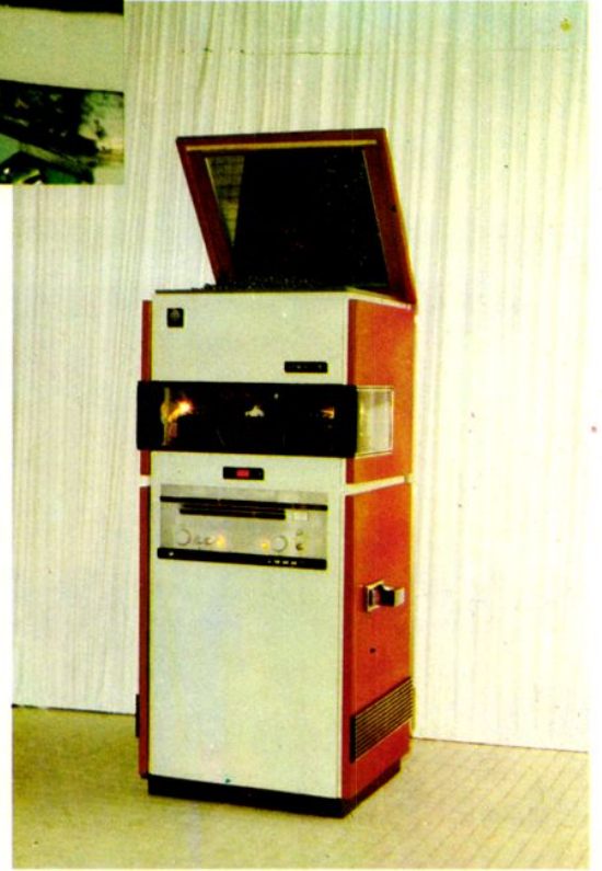
QWY-2 鋼球渦流自動檢查儀
