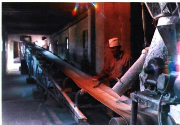
▲洗衣粉生产线最后一道工序，将洗衣粉输送到粉仓
