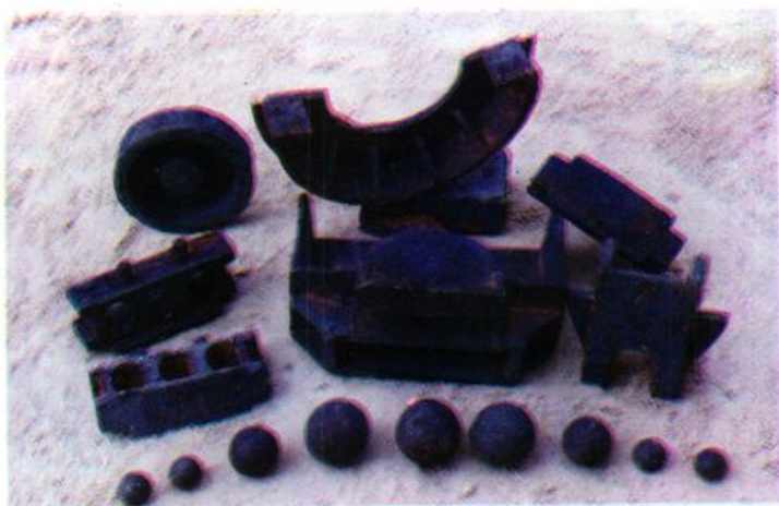
铸造厂生产的高铬钢铸件
