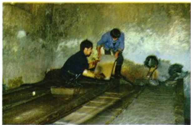
混汞室正在刮取汞膏
