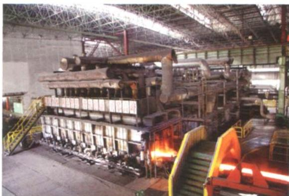
中小型步进梁式连续加热炉
