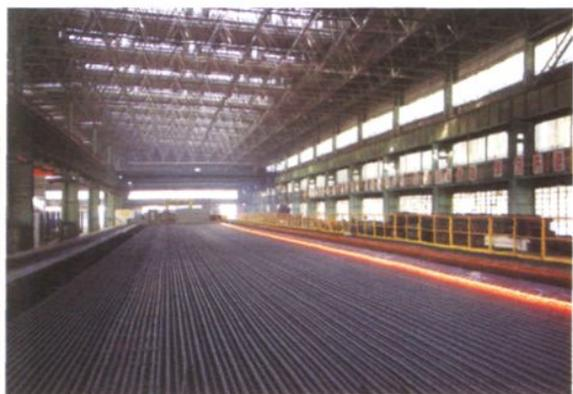
中小型步进齿条式冷床
