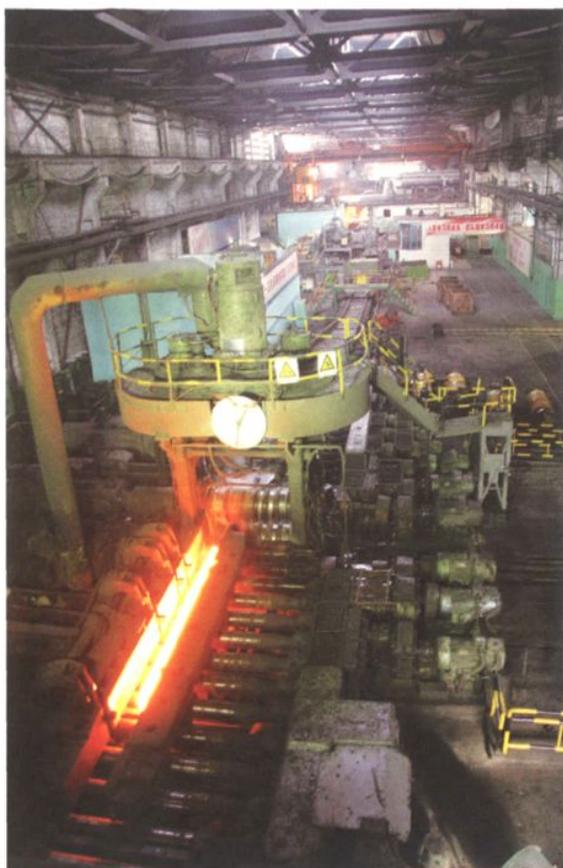
改造后的 750mm 初轧机正在轧制大圆钢
